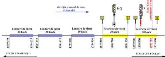
Limitări și restricții de viteză pe firul I de circulație între stația CFR GUGEȘTI și H.m. COTEȘTI
