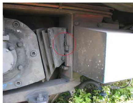
Foto 9 - adaosurile de cântărire ieșite din poziția normală
